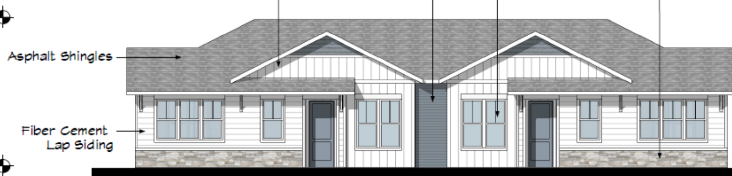
FRONT ELEVATION - PH2 DUPLEX
